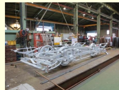
工場で補修している台車
