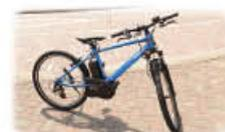
スポーツタイプの電動アシスト自転車
